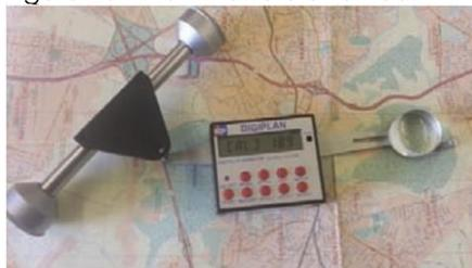
Figura 26 - Uso do planímetro eletrônico.
